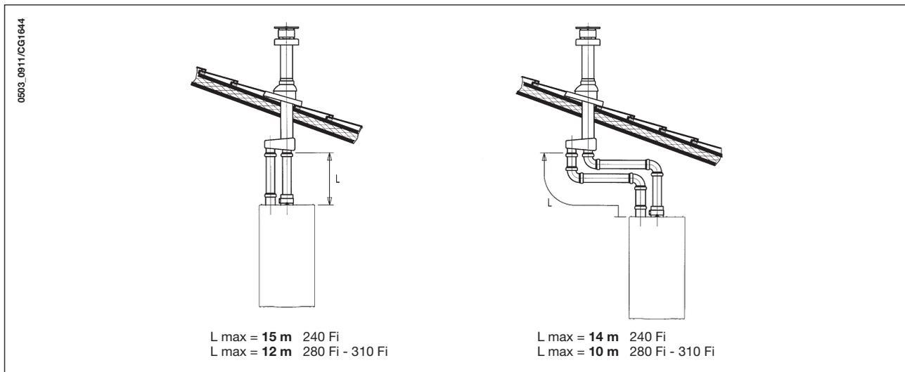
**Importante:** el conducto individual para la descarga de los productos de la combustión se debe aislar de forma adecuada, en los puntos donde está en contacto con las paredes de la vivienda, con un aislamiento apropiado (por ejemplo una manta de fibra de vidrio).
