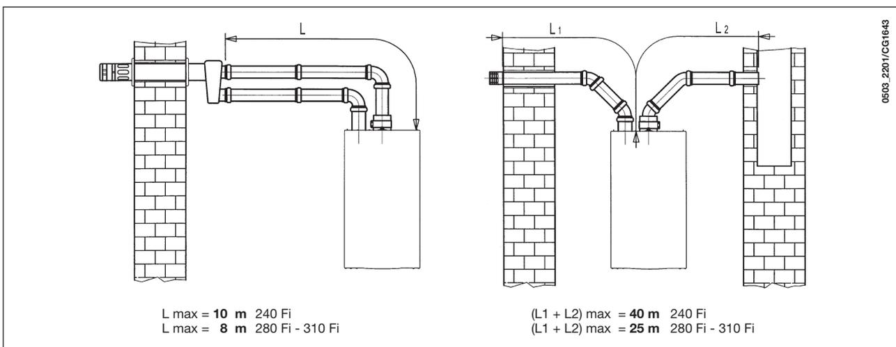
**N.B.:** para los tipos C52 los terminales para la aspiración del aire comburente y para la descarga de los productos de la combustión no se deben situar en las paredes opuestas al edificio.
