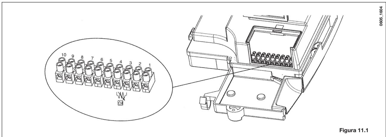
Con la sonda exterior conectada, el dispositivo de control de la temperatura del circuito desempeña la función de regulación del coeficiente de dispersión **Kt**. Para ajustar las curvas (1...90) pulsar las teclas +/-  $\square$ .
